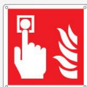
Allarme antincendio F005
